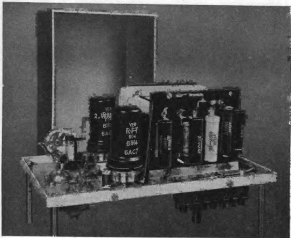
167. ábra. Nagystabilitású vezérosszillátor, elválasztó fokozattal
